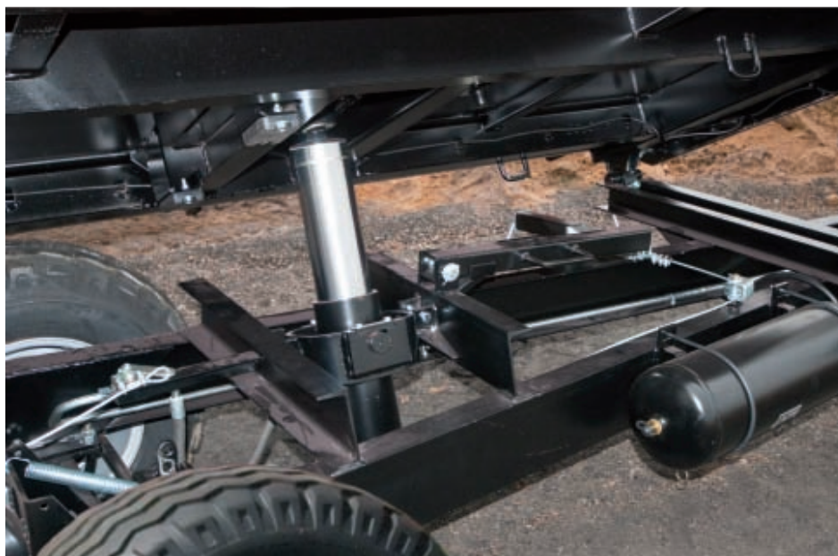
Zastosowanie teleskopowego cylindra oraz sprawdzonego kulowego systemu wywrotu umożliwia trójstronny wywrót skrzyni ładunkowej
