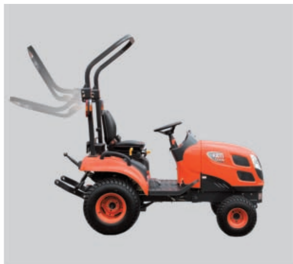
Składany pałak zabezpieczający pozwala łatwo manewrować w trudnych warunkach
