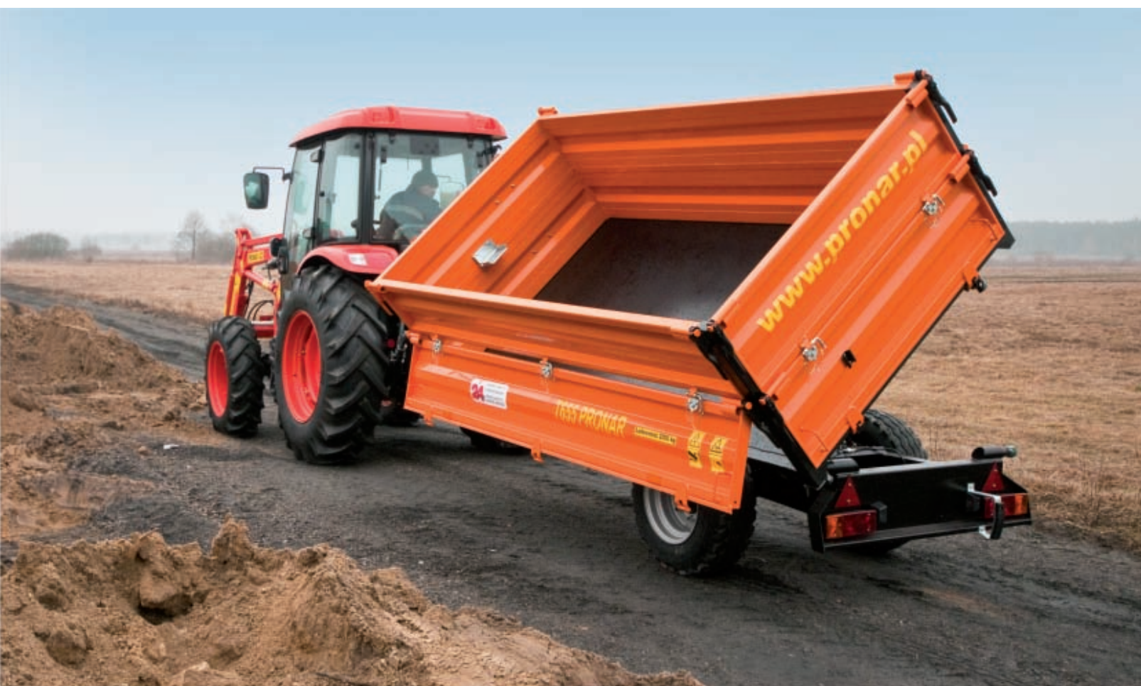
Zastosowanie teleskopowego cylindra oraz sprawdzonego kulowego systemu wywrotu umożliwia trójstronny wywrót skrzyni ładunkowej
