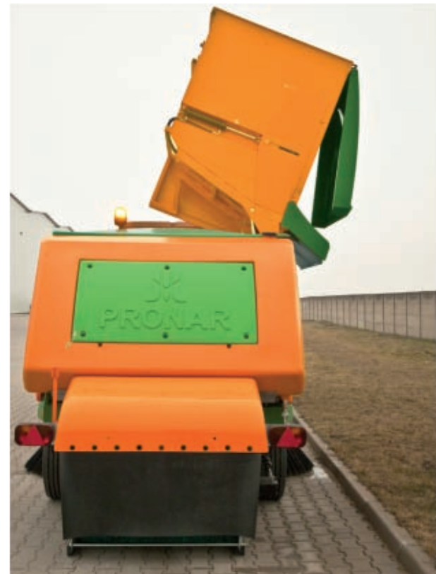
Zamiatarka opróżniana może być na wysokości 2,2 m. Specjalny zespół kłap i zsydni pozwala na dokładny rozładunek, np. na ciężarówkę lub przyczepę
