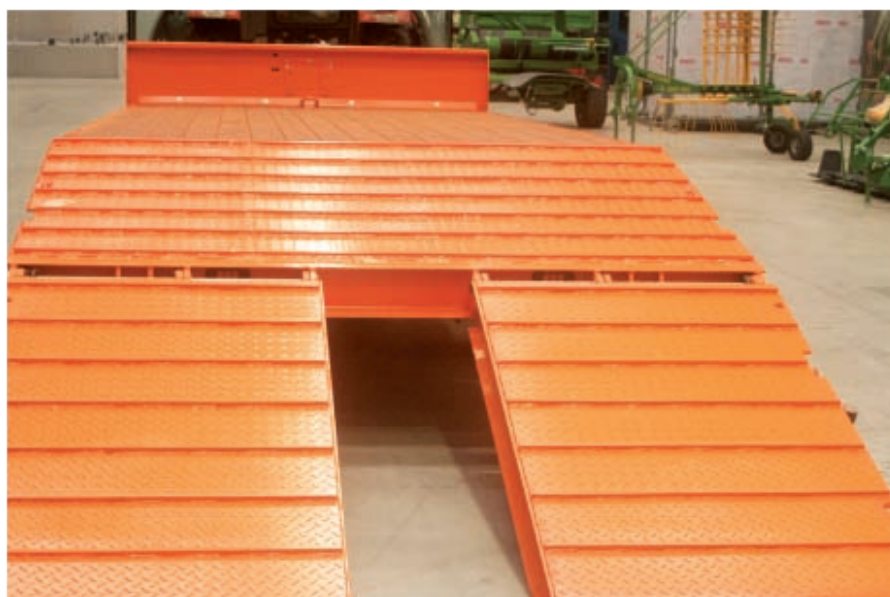
Mały kąt i poprzeczne wypukłości części pochyłej ułatwiają załadunek
