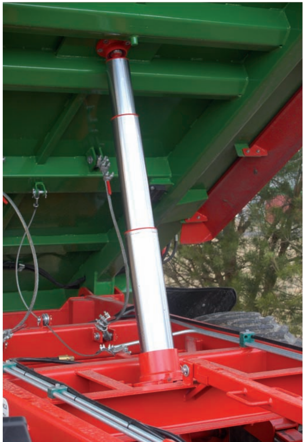
Mechanizmem montowanym standardowo w przyczepie jest hydrauliczna instalacja wywrotu z cylindrem teleskopowym
