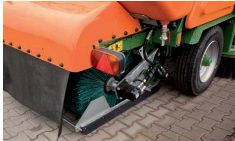
Tylna szczotka walcowa podmiatająca zanieczyszczenia na przenośnik taśmowy, który transportuje zanieczyszczenia do pojemnika
