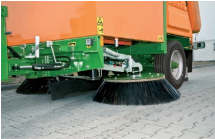
Szczotki talerzowe z regulacją szerokości zamiatania. Dodatkowy docisk do podłoża pomaga w usuwaniu zanieczyszczeń
