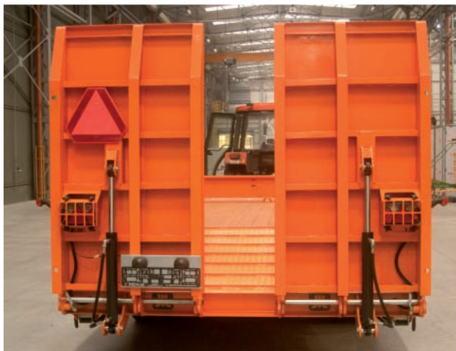
W przyczepie zastosowano hydrauliczny system obsługi najazdów
