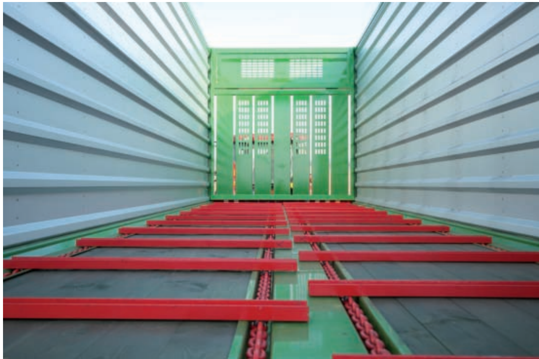
Wyładunek z przyczepy T400 umożliwia cztery łańcuchy przenośnika podłogowego
