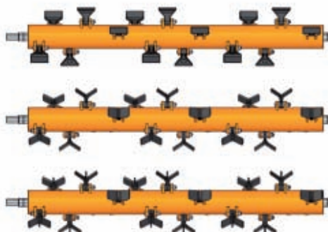
Od góry: noże młotkowe, odgięte w układzie Y, odgięte w układzie YI
