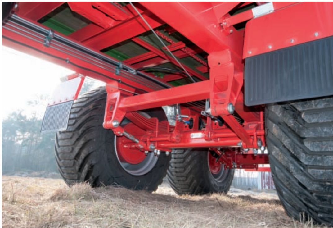
Zawieszenie typu tandem na resorach parabolicznych oraz biernie sterowana oś tylna znacznie ułatwiają manewrowanie przyczepą
