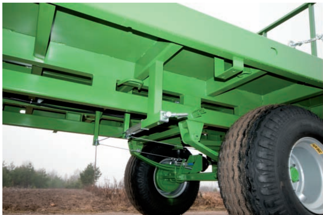
Płyta podłogowa jest wykonana z blachy o grubości 4 mm
