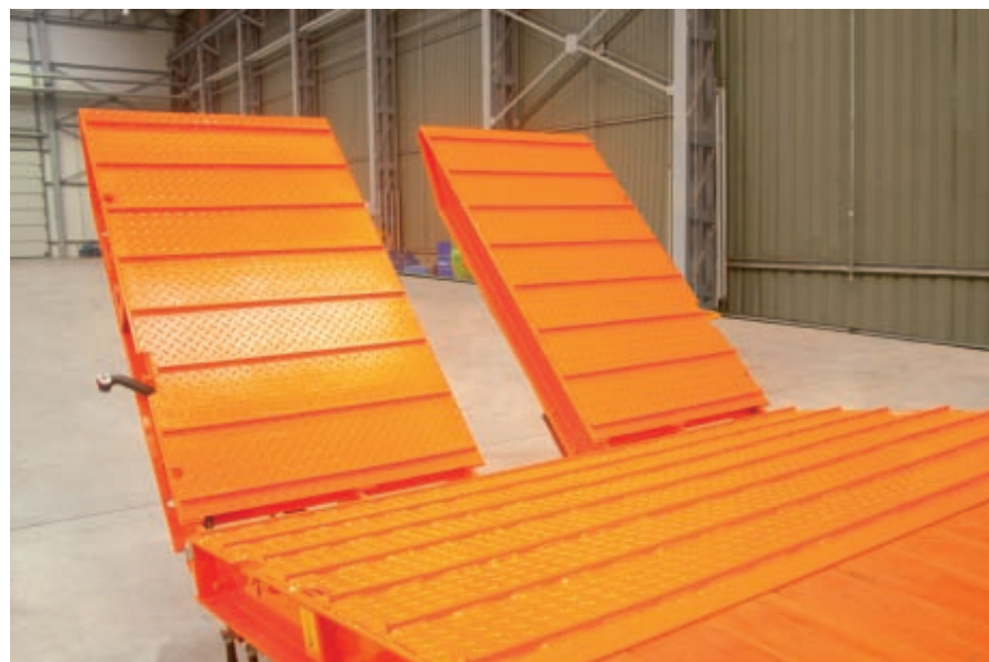
Szerokie najazdy umożliwiają załadunek/rozładunek maszyn o różnej szerokości
