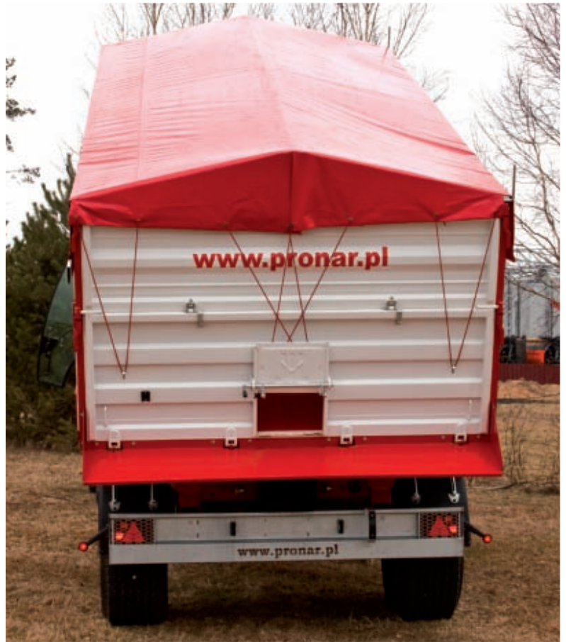
Szyber do ziarna i rylna zsympowa z tyłu na całej szerokości
