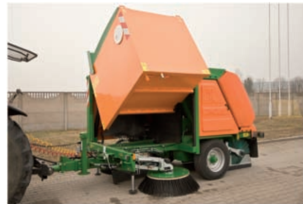
Pojemny zbiornik na zanieczyszczenia (poj. 3 m 3 ) opróżniany jest za pomocą wywrotu hydraulicznego
